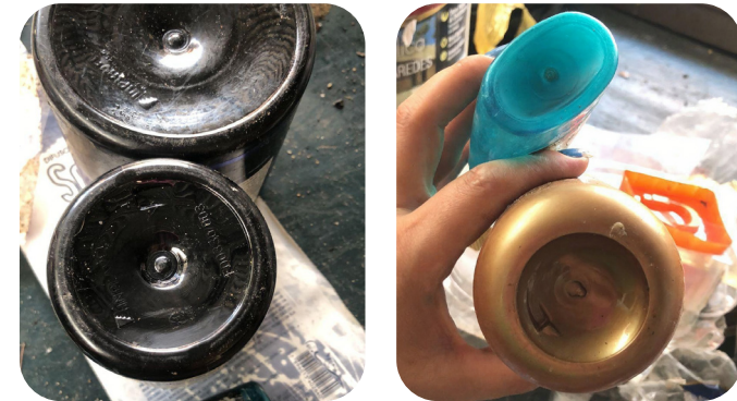
Figura 14. Detalhe para identificação dos frascos PET
