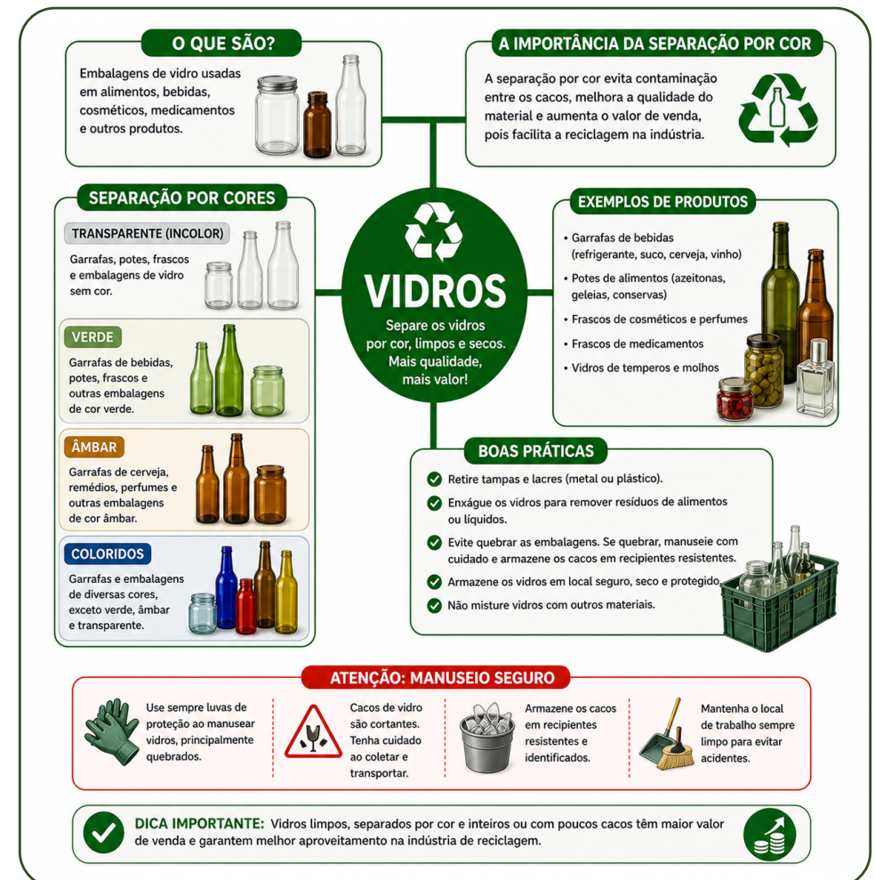
Figura 10. Separação dos vidros por tipo
