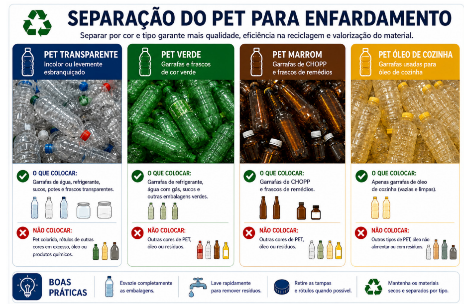
Figura 15. Cuidados para formação dos fardos de PET
